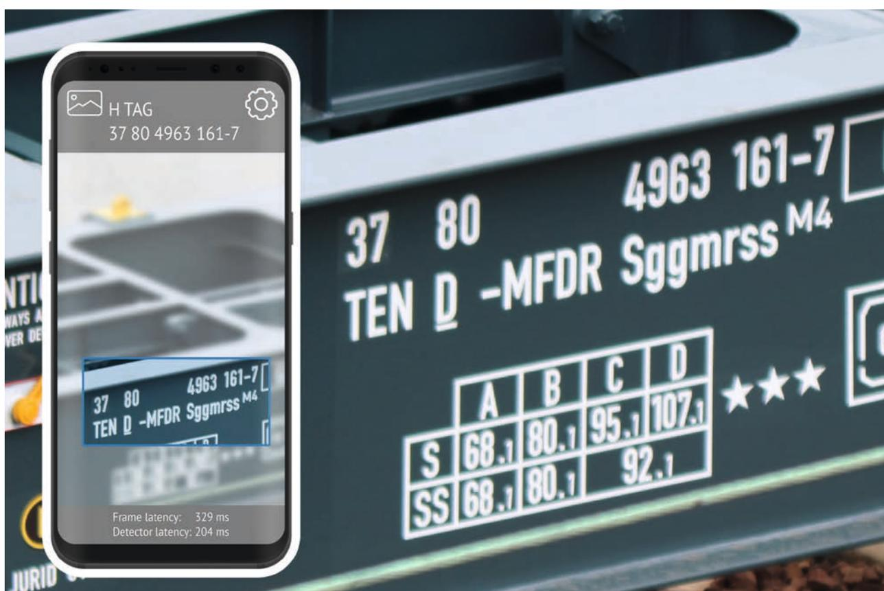
Um manuelle Eingabeprozesse im Logistikmanagement zu reduzieren, hat die ZEDAS GmbH für EVUs im Güterverkehr eine KI-basierte Wagennummernerkennung entwickelt.
