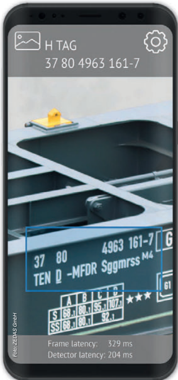
Die KI-basierte Anwendung erkennt die Wagennummer
