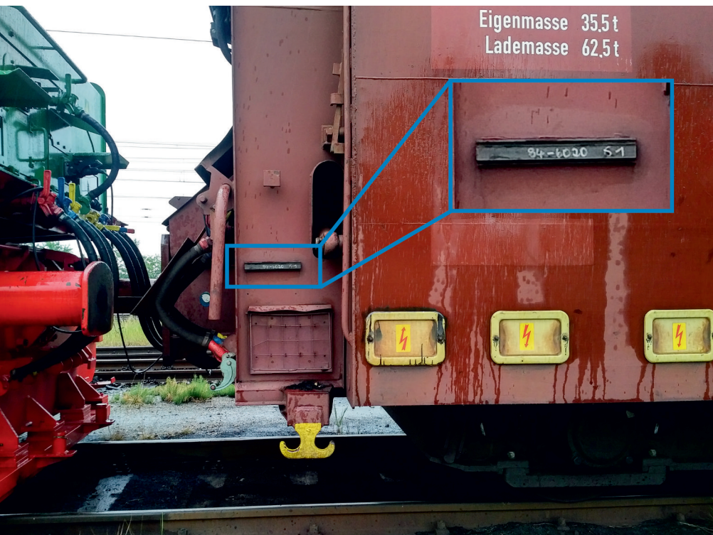
Abb. 1: RFID-Tag am Güterwagen
