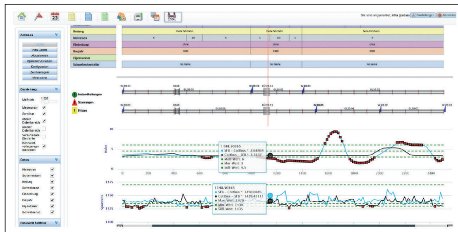
Abb. 2: zedas asset Track Analyser – Messdaten mit Kennwertverletzung
