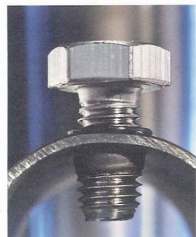
Das Verfahren erzeugt kein Zusatzgewicht, denn die Buchsen werden aus dem Material geformt, welches beim herkömmlichen Bohren als Späne anfällt. Bilder: Ontool
